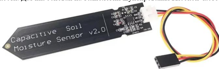
Рис.3. Ёмкостной датчик влажности почвы
